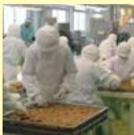
梅干し製品の最終工程。計量やパック詰め、包装等の作業を経て、いよいよ完成します。効率の良い製造ラインの整備と昔ながらの手作業をバランスよく組み合わせています。
